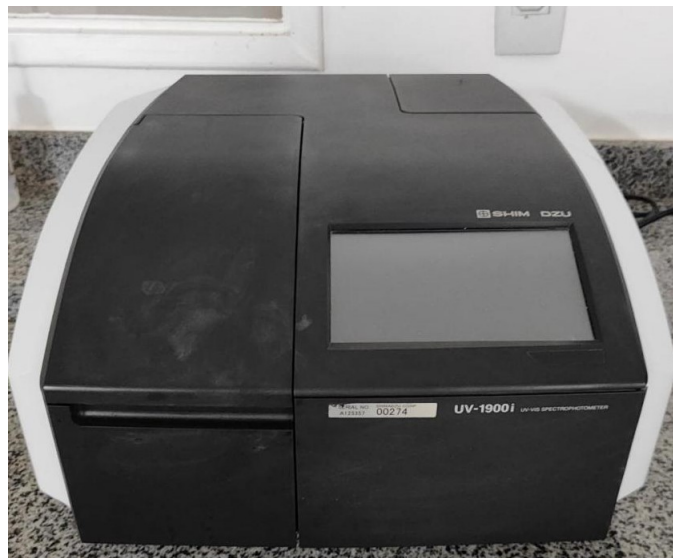
Figura 9: Espectrofotômetro UV-VIS 1900i Shimadzu utilizado no ensaio de DQO.
