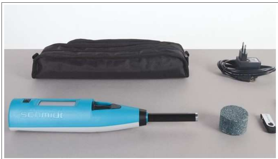
Figura 14 – Modelo do Martelo de Schmidt.
