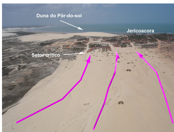
Figura 34 – Dunas originadas nos últimos 5 anos a partir do incremento do tráfego de veículos e das obras de requalificação urbana. As areias estão migrando na direção da vila e soterrando residências, pousadas, edifícios públicos e ruas no interior da vila.
