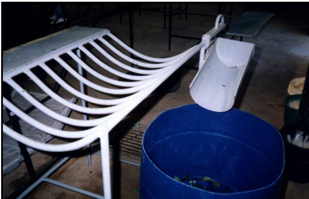
Foto 33 - Equipamento de Fechamento dos Bonches (Boncheadora) Fonte: Luzianny Rocha, 2004. (Registro Próprio).
