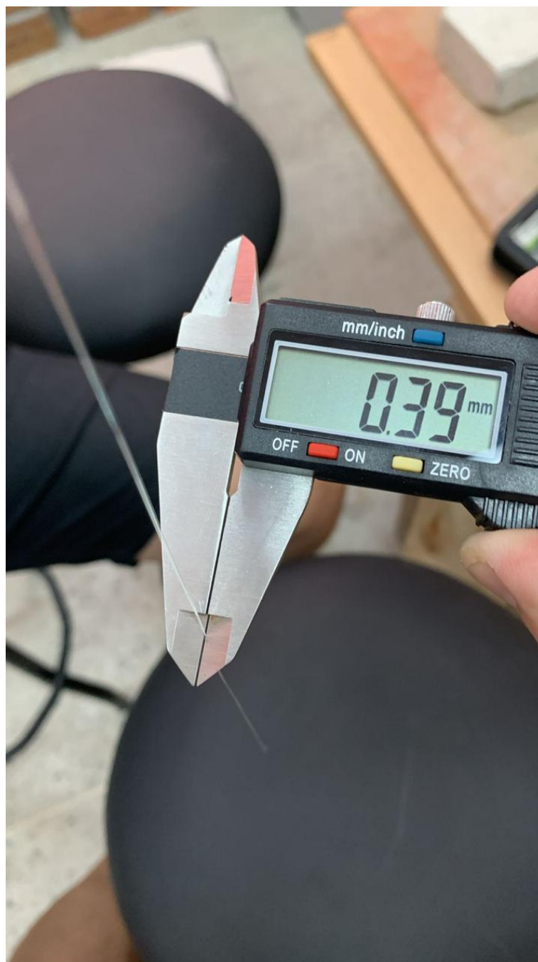
Figura 6 - Diâmetro das fibras ópticas poliméricas utilizadas
