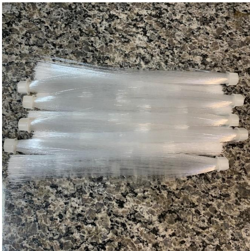
Figura 4 - Fibras utilizadas para fabricação do concreto translúcido
