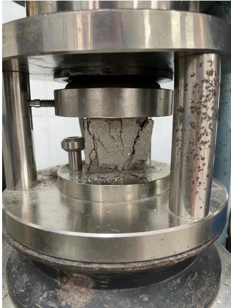
Figura 23 - Corpo de prova após ser rompido
