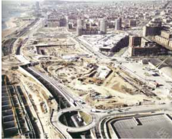
Figura 3.45. A reforma urbanística de Besòs : a continuação do tratamento da frente marítima da Vila Olímpica em direção à extensão da Avenida Diagonal . Intervenções estratégicas para a criação de uma nova centralidade. Em destaque as obras de adequação da central de tratamento de águas e de rebaixamento da Ronda del Litoral , sobre a qual foi edificada a grande esplanada do Fórum 2004. Fonte: Ajuntamiento de Barcelona, 2007.
