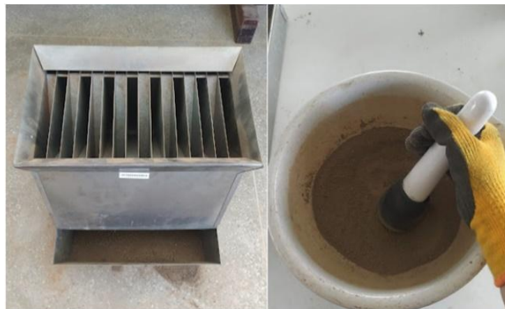
Figura 7 - Quarteamento e destorroamento das amostras.
