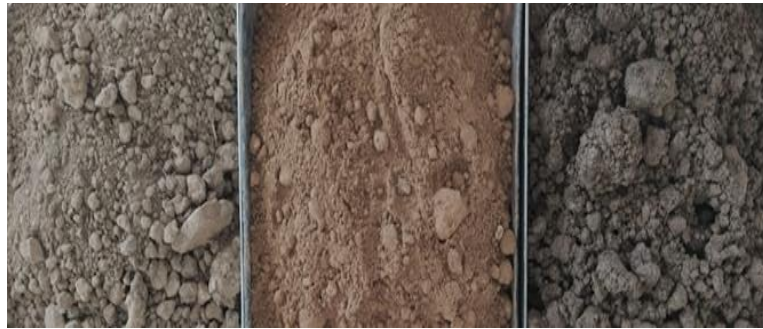
Figura 6 - Amostras de (a) argila gorda (b) argila magra e (c) mistura de argila gorda e magra.
