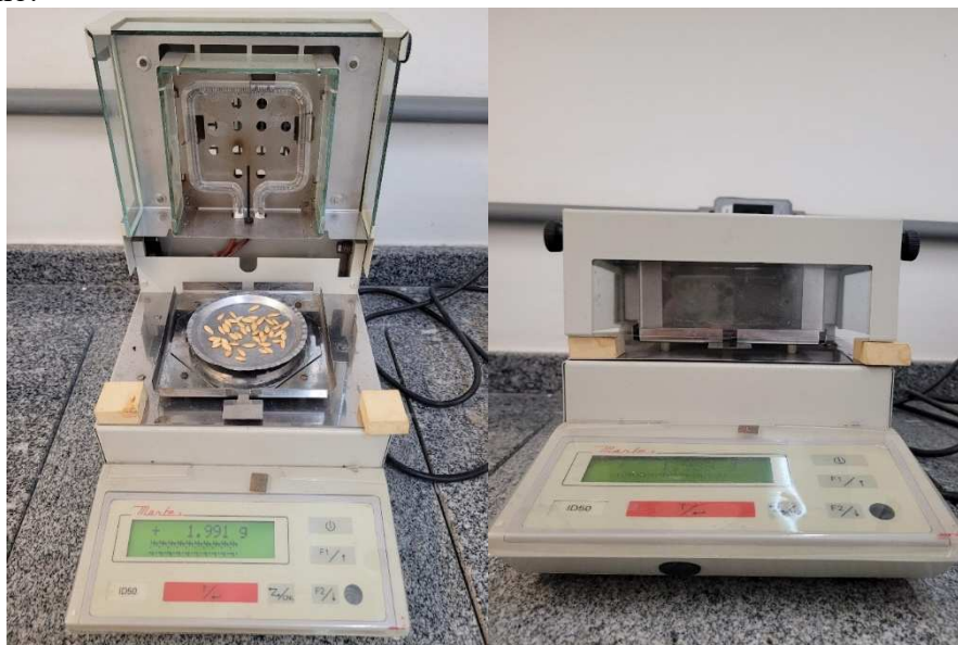
Figura 10 – Análise de umidade das sementes de melão na balança com aquecimento por infravermelho.
