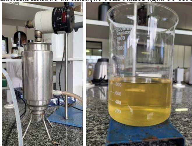
Figura 11 – Reator e material filtrado da extração com etanol/água do óleo da semente do melão.
