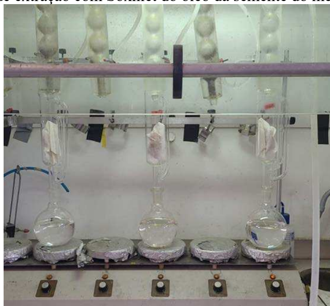
Figura 12 – Sistema de extração com Soxhlet do óleo da semente do melão.
