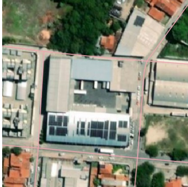
Figura 2 — Quadra classificável para a vetorização por conter apenas telhados metálicos.
