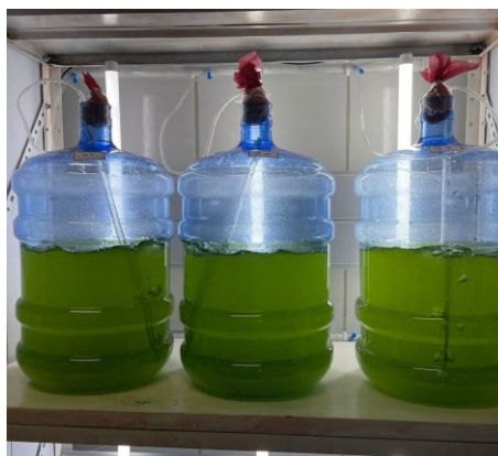
Figura 2. Reatores com cultivos da microalga Scenedesmus obliquus .
