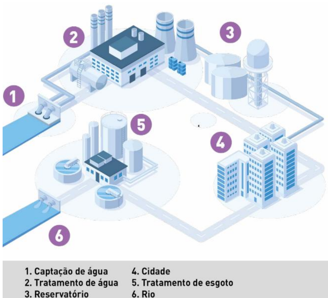
Figura 6 – Sistema de Tratamento de Água e Esgoto
