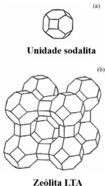
Figura 3 - Estrutura cristalina da zeólita LTA.
