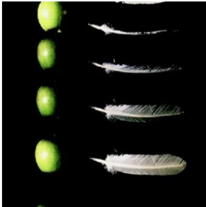
Figura 4. Experimento de queda livre no vácuo (sem a ação da resistência do ar).
