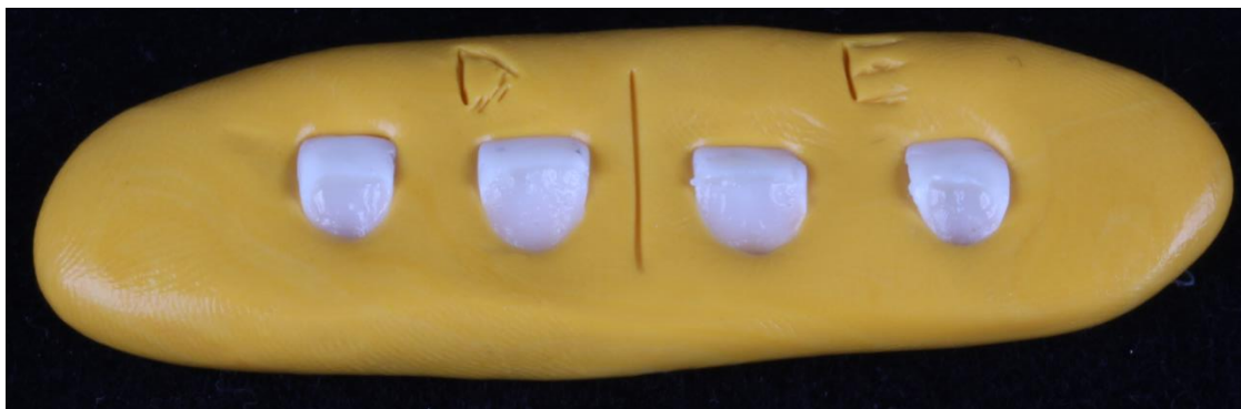
Figura 7 - Pistas Planas fixadas, identificadas e preparadas na matriz de silicone.
