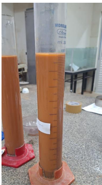
Figura 14 - Ensaio de granulometria: etapa de sedimentação.
