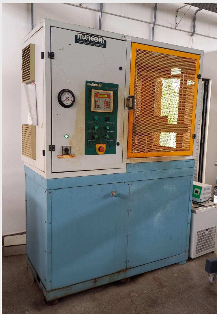
Figura 31 - Prensa aquecida a 180°C
