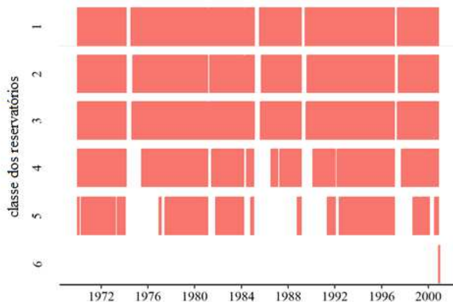
Figura 18 - Períodos de demanda de água não atendida por classe de reservatório, destacados em vermelho, na Bacia do Alto Jaguaribe durante a Era 3
