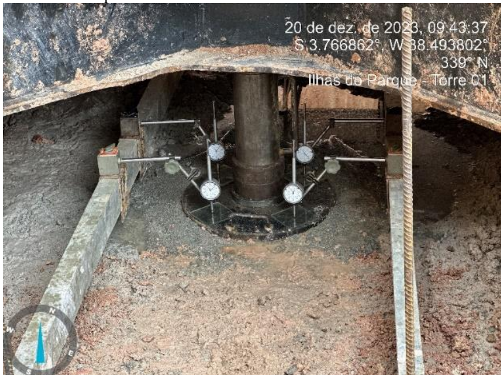
Figura 19 – A placa circular metálica utilizada no ensaio de carga com deflectômetros posicionados
