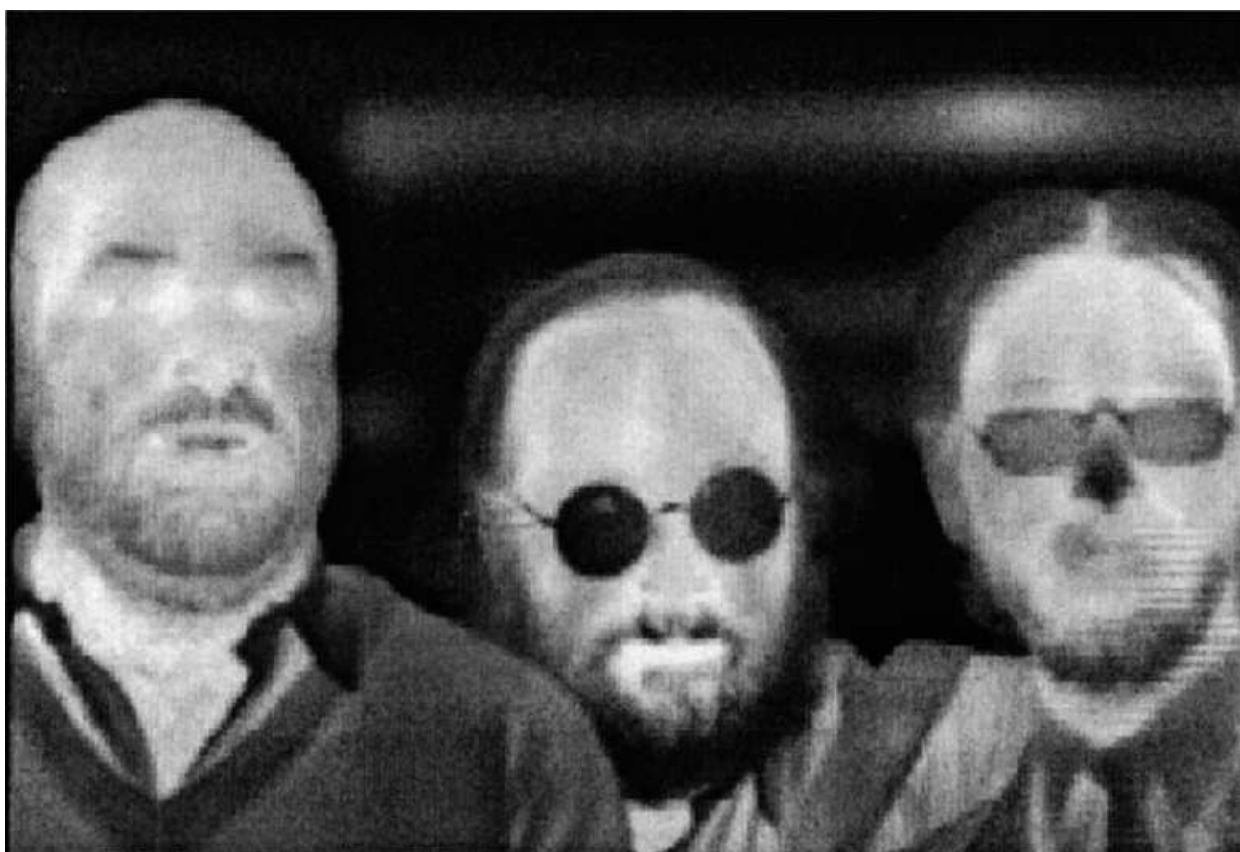
Figura 4: Imagem térmica produzida por uma câmera infravermelha explorando a tecnologia de detecção de cerâmica piezoelétrica não resfriado.
