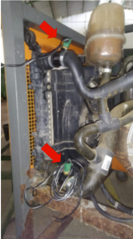
(a) Sensores na entrada (superior) e saída (inferior) do radiador
