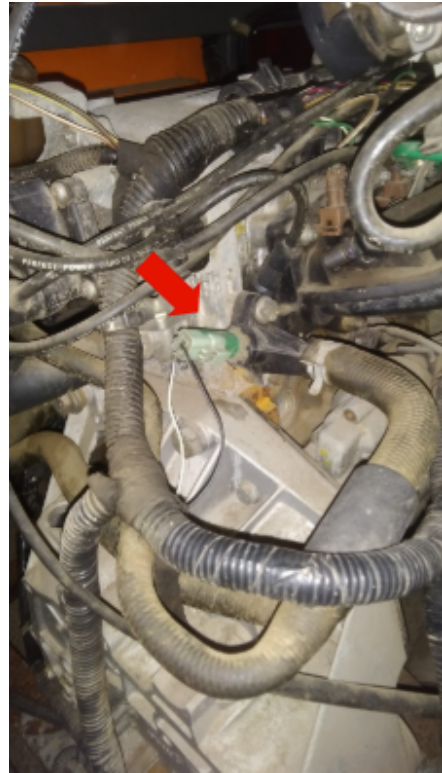
(b) sensor do motor antes da válvula termostática
