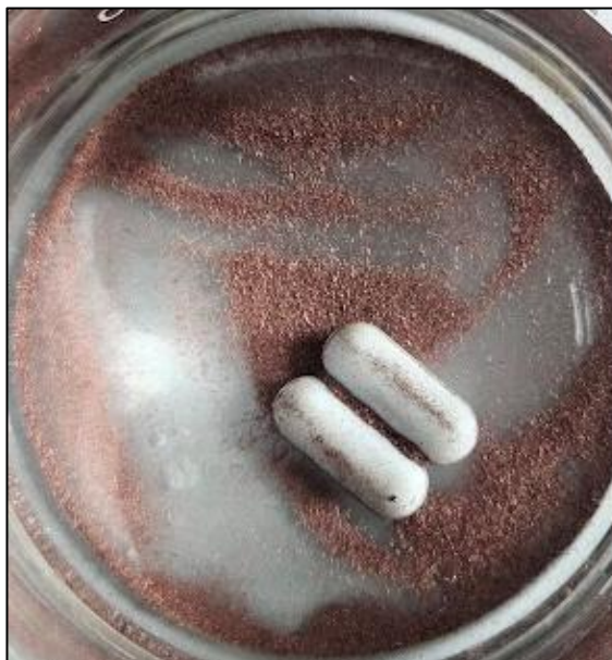
Figura 16 – Cementado após remoção de cementante em excesso.
