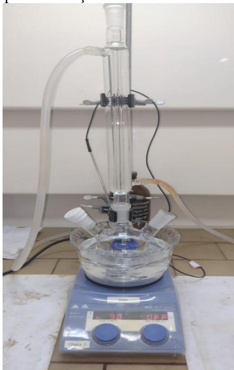
Figura 3 – Montagem equipamento para lixiviação
