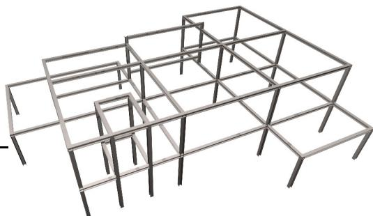
Vigas e Pilares em estrutura metálica módulo 6x6 m
