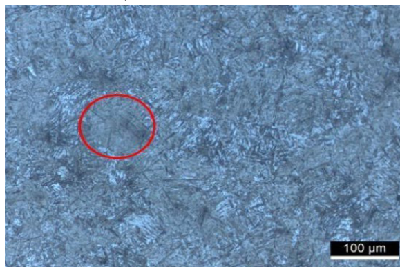
Figura 14 – Imagem em Microscopia Óptica do Aço 1045 Temperado em água. Martensitas em marcação vermelha (aumento de 200x).
