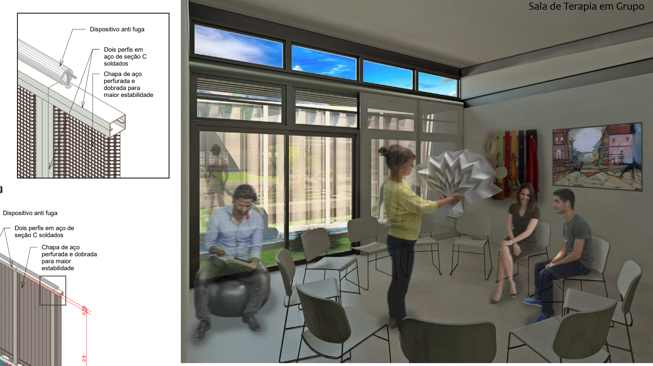
Perspectiva esquemática do painel perfurado na área de IAA | 1:50
