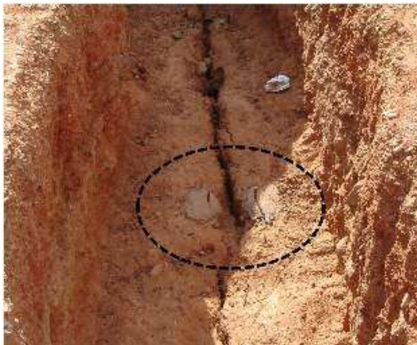
Figura 47 – Marcos de deslocamento superficial utilizados no monitoramento de fissuras em Piaus
