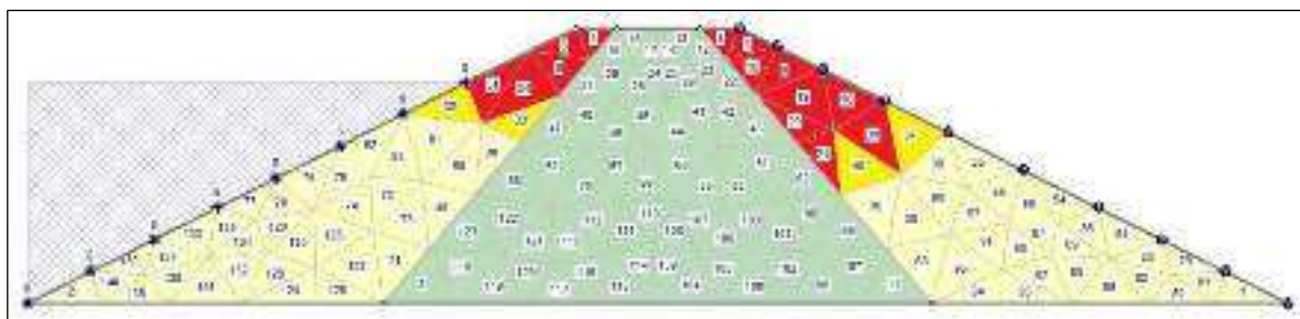
Figura 26 – Tensões de tração verificadas na modelagem associada de Maia (2022) para a situação de barragem zoneada, sem a presença de elemento filtrante
