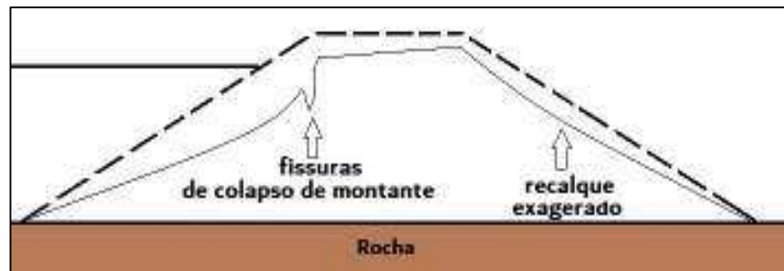
Figura 5 – Fissuramento a montante causado por colapso decorrente de umedecimento do solo
