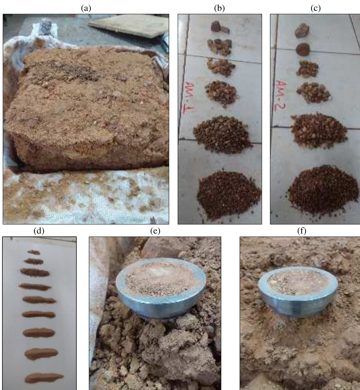
Figura 55 – Detalhes das amostras de solo de Piaus durante a realização dos ensaios de laboratório: (a) bloco indeformado; (b) frações do peneiramento grosso da Amostra 01; (c) frações do peneiramento grosso da Amostra 02; (d) frações do peneiramento fino; (e) Preparação da Amostra 01 para ensaio edométrico; e (f) Preparação da Amostra 01 para ensaio edométrico.
