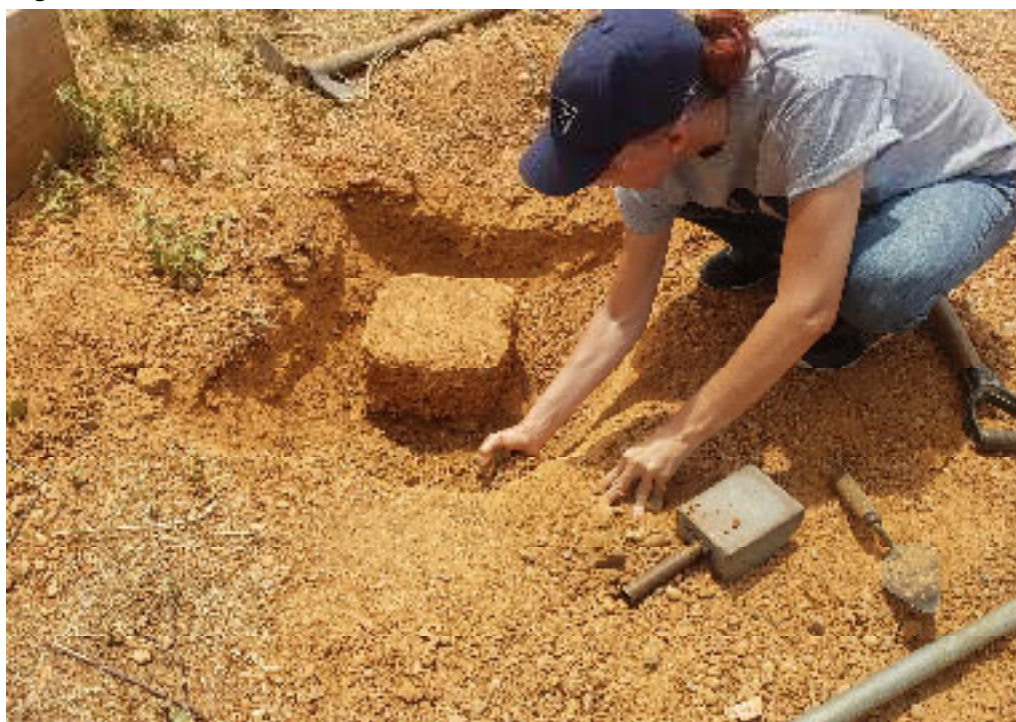
Figura 54 – Coleta de bloco indeformado de solo na ombreira direita de Piaus
