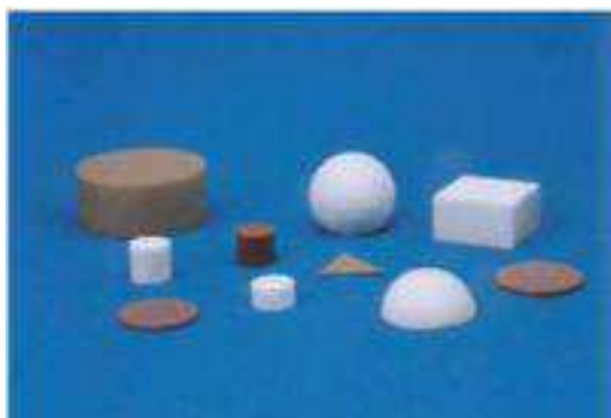
Figura 1 – Antenas ressoadoras com cerâmicas avançadas em diversas geometrias
