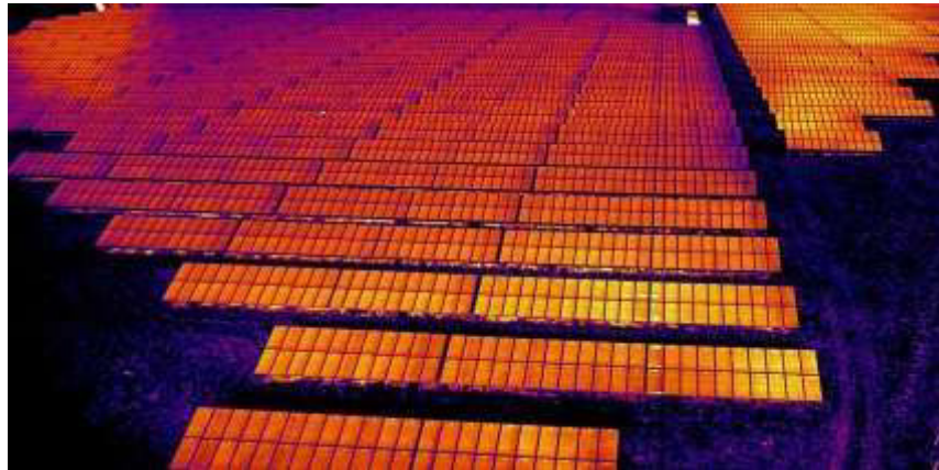
Figura 12 - Foto termográfica de um complexo solar
