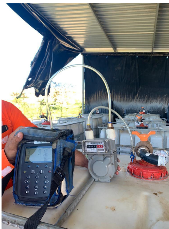
Figura 10 - Medição da vazão e composição do gás nos reatores instalados na GNR/ASMOC
