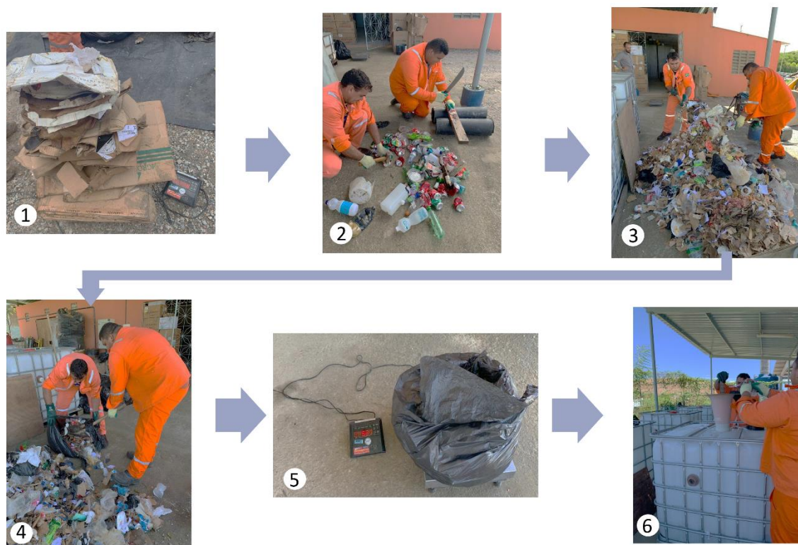
Figura 5 - Processo de pesagem, trituração, homogeneização e distribuição dos resíduos sólidos nos reatores
