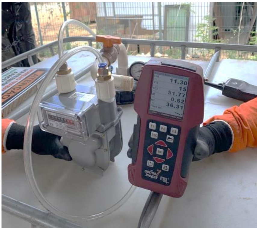
Figura 2 -Medição de vazão e composição do biogás
