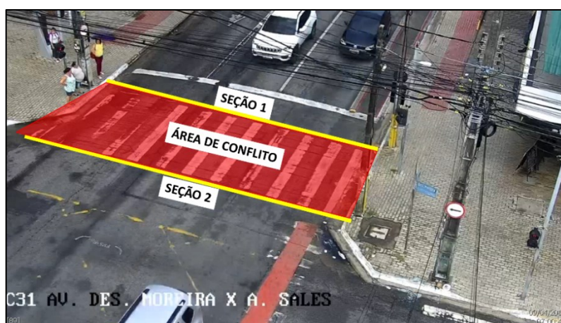
Figura 10 - Delimitação da área de conflito e das seções de coleta dos instantes de passagem para headways e velocidades veiculares
