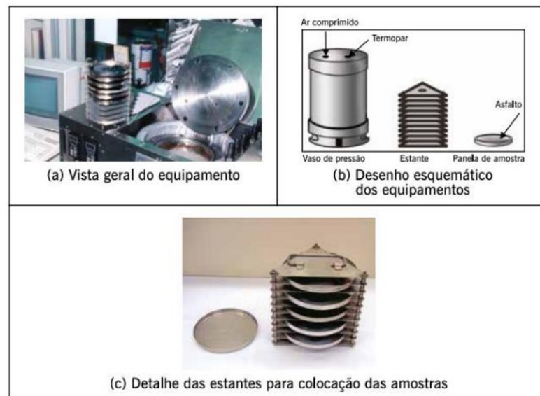
Figura 3 – Vaso de envelhecimento sob pressão ( Pressure aging vessel - PAV)
