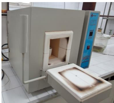
Figura 7 - Representação da máquina como forno mufla com teor de cinza com três cadinhos no filé da sardinha-verdadeira ( Sardinella brasiliensis )
