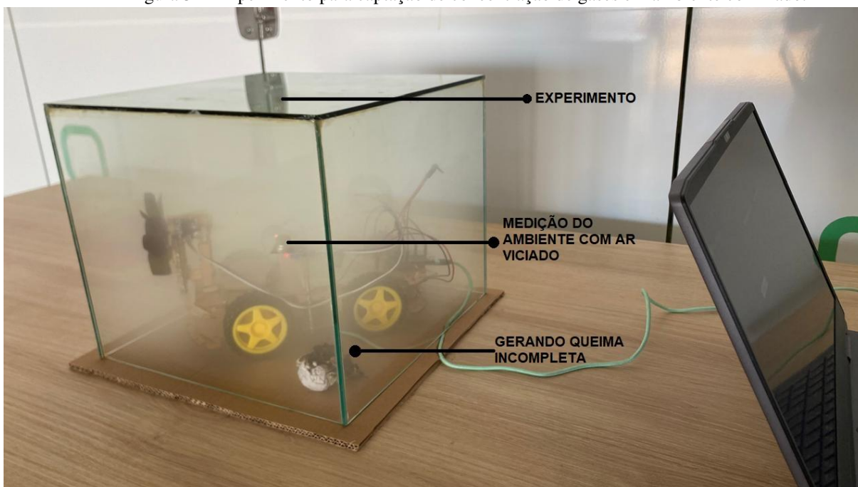
Figura 52– Experimento para captação de concentração de gases em ambiente confinado.
