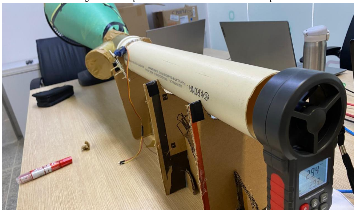
Figura 57- Medição no túnel de vento com o anemômetro profissional.
