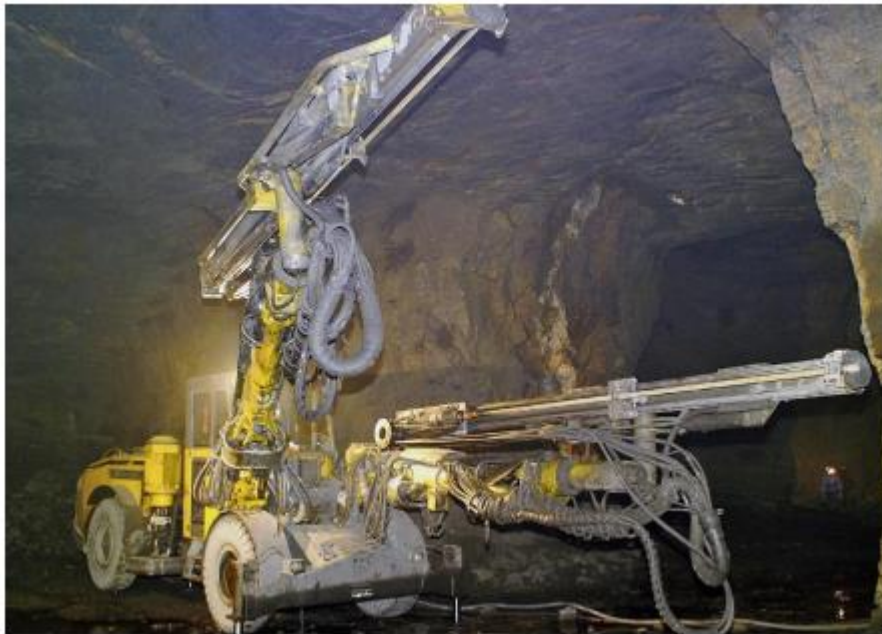
Figura 15 - Carreta jumbo com duas lanças para perfuração.
