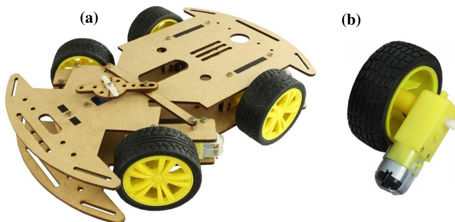
Figura 42- (a) Partes do chassi de MDF e (b) Conjunto roda motor.
