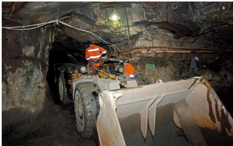
Figura 16 - Operações com LHD em galerias de mina subterrânea.
