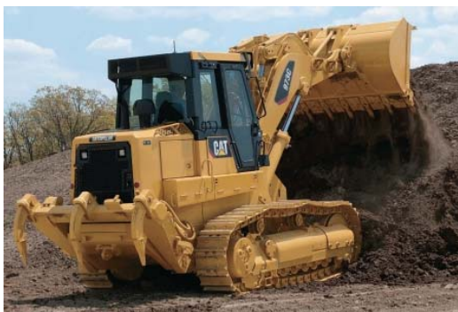
Figura 2.15: Carregadeira de esteiras. Fonte: VIA RURAL (2012).
