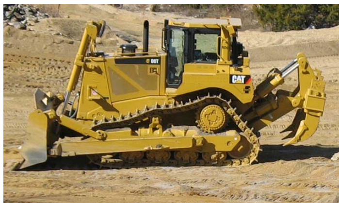
Figura 2.7: Trator de lâmina com escarificador acoplado à parte traseira. Fonte: HEAVY EQUIPMENT FORUMS (2012a).
