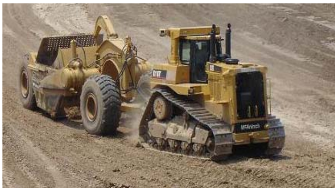
Figura 2.9: Scraper de dois eixos rebocado por trator de esteiras. Fonte: HEAVY EQUIPMENT (2012a).
