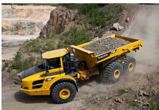
Figura 2.28: Caminhão fora-de-estrada articulado. Fonte: VOLVO (2012).
