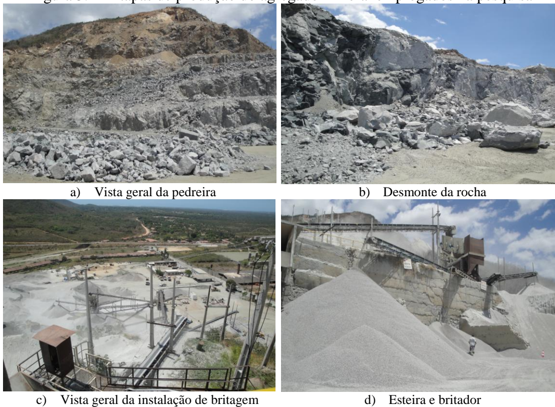
Figura 3.4 - Etapas de produção do agregado mineral empregados na pesquisa
