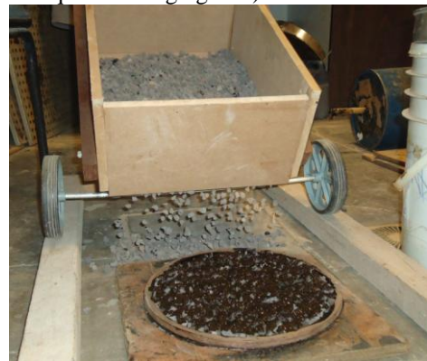
d) Aplicação da taxa de agregado da 2ª camada
