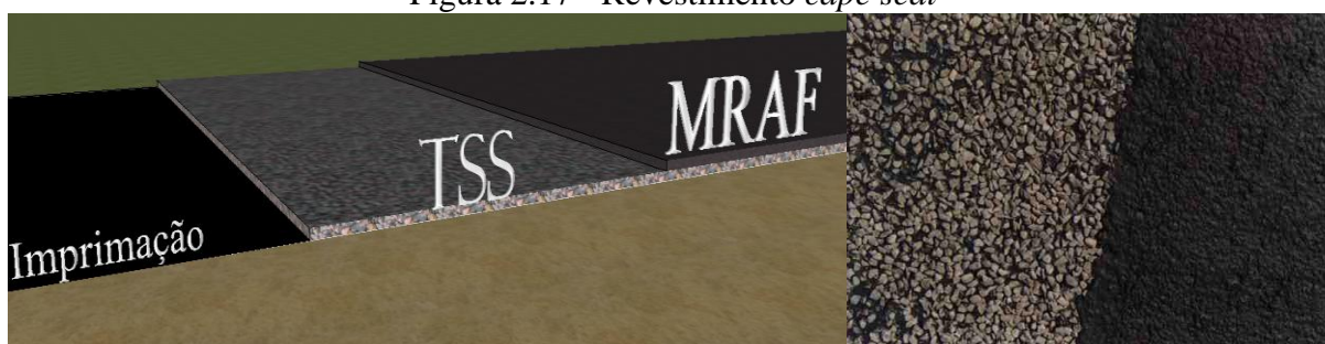
Figura 2.17 - Revestimento cape seal
