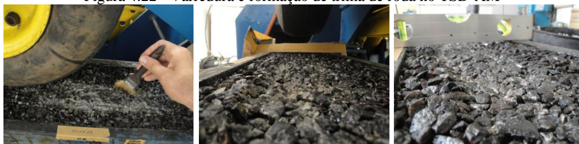
Figura 4.22 - Varredura e formação de trilha de roda no TSD-AM
