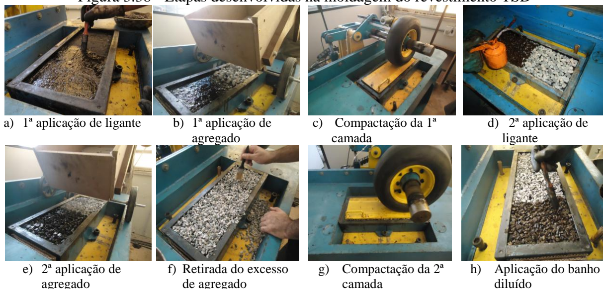
Figura 3.38 - Etapas desenvolvidas na moldagem do revestimento TSD
