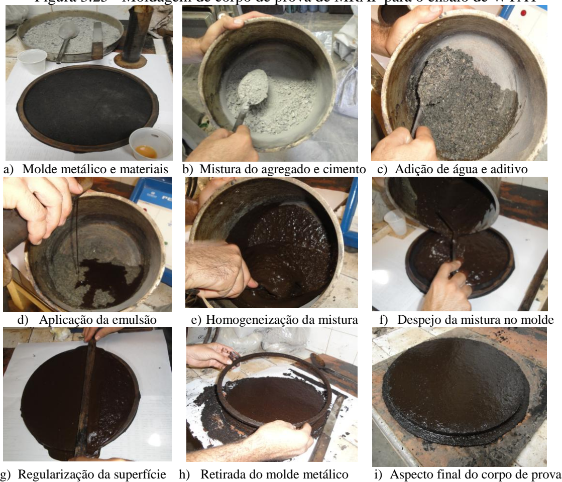
Figura 3.25 - Moldagem de corpo de prova de MRAF para o ensaio de WTAT
