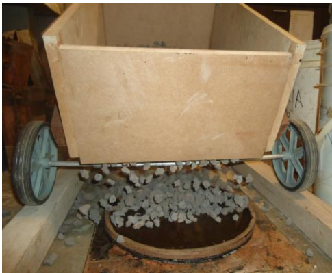
c) Aplicação da taxa de agregado da 1ª camada
