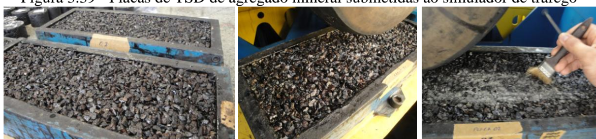
Figura 3.39 - Placas de TSD de agregado mineral submetidas ao simulador de tráfego
