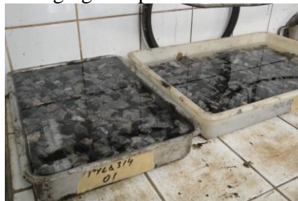
Figura 3.12 - Imersão dos agregados para os ensaios de absorção e densidade
