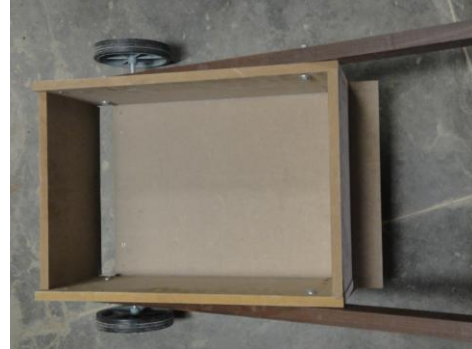
b) Vista superior (detalhe da abertura de queda dos agregados)
