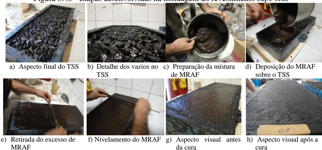
Figura 3.43 - Etapas desenvolvidas na moldagem do revestimento cape seal
