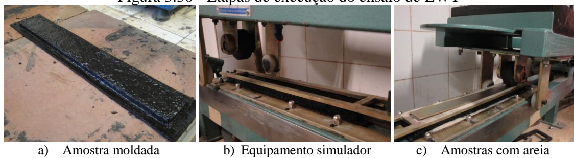
Figura 3.30 - Etapas de execução do ensaio de LWT
