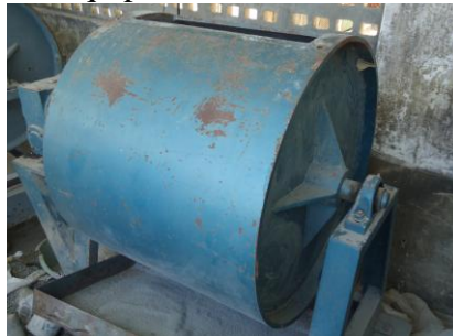
Figura 3.11- Equipamento de abrasão Los Angeles
