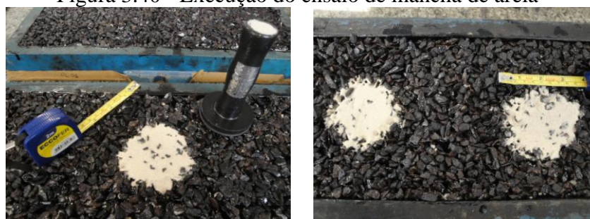
a) Materiais utilizados no ensaio b) Medição do diâmetro da mancha Fonte: Autor (2013).
