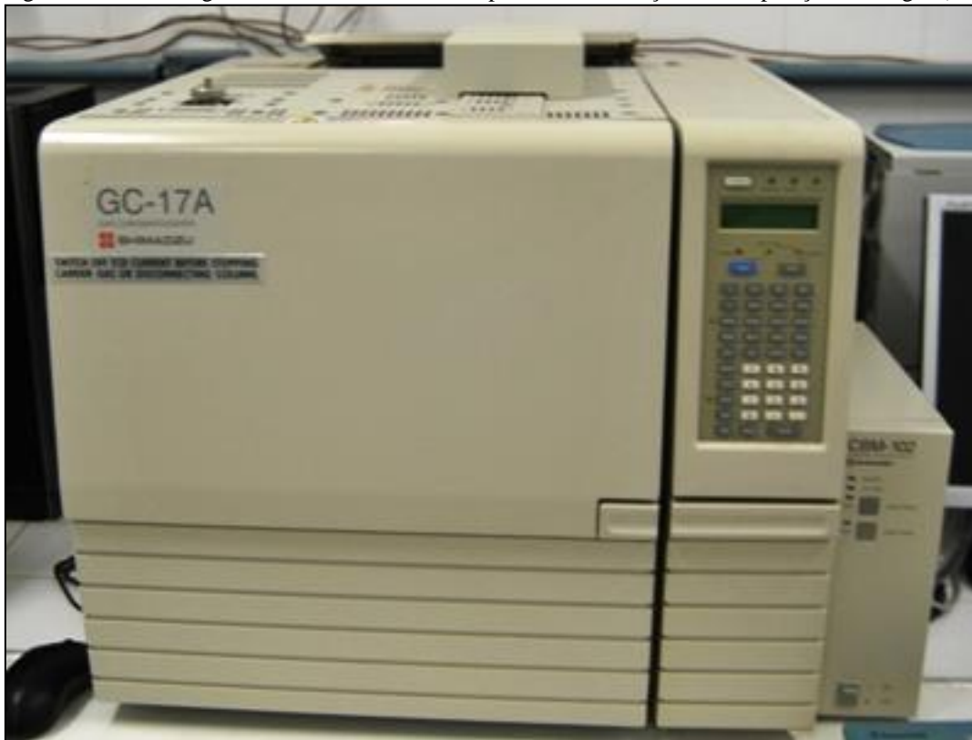
Figura 13 - Cromatógrafo GC17A-TCD utilizado para a determinação da composição do biogás (Ar; CH 4 ; CO 2 ).
