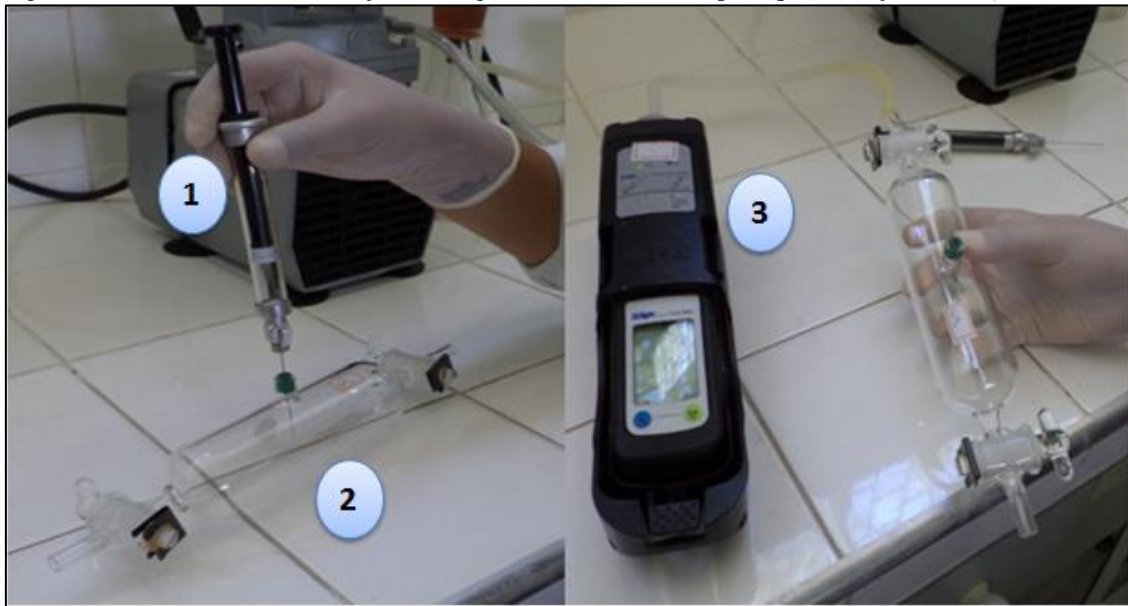
Figura 14 - Procedimento de diluição do biogás em bulbo de vidro para quantificação de NH 3 e H 2 S.
