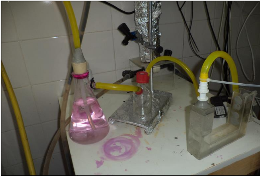
Figura 6 - Sistema de lavagem cáustica utilizada no reator R1.
