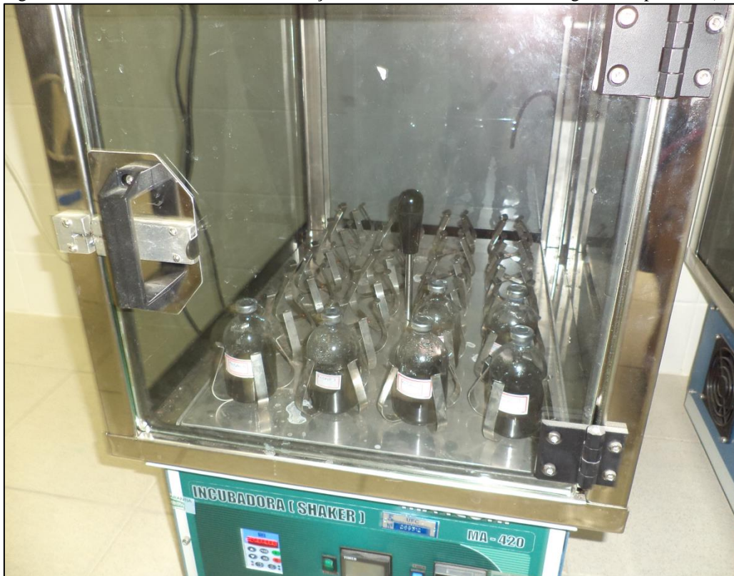
Figura 8 - Incubadora utilizada na realização do teste de Atividade Metanogênica Específica (AME).
