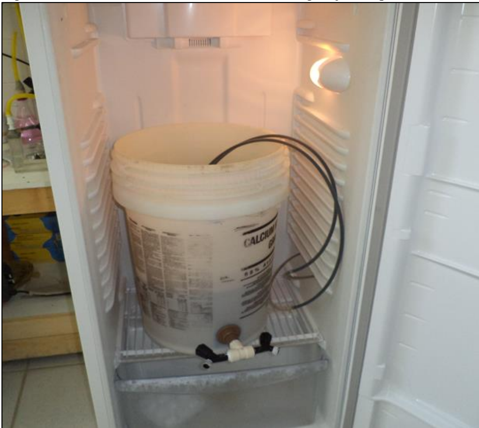
Figura 7 - Armazenamento do afluente sob refrigeração, o qual alimentava ambos os reatores.
