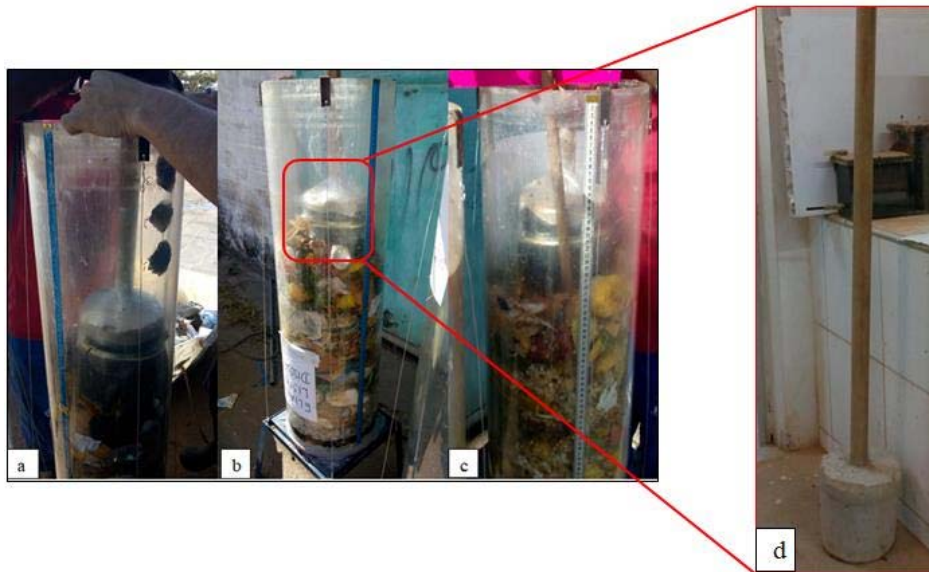
Figura 37 – Compactação dos resíduos com o compactador de concreto
