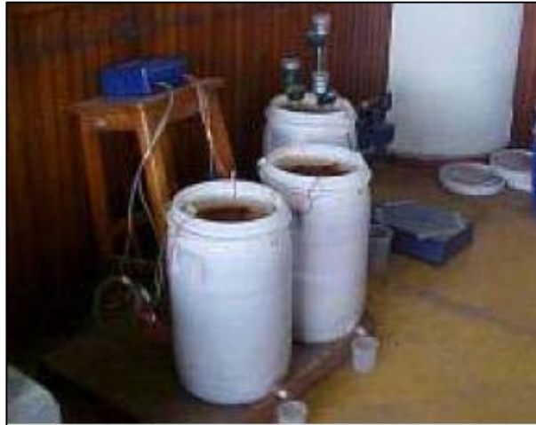
Figura 13 - Lisímetros para simular camada de cobertura de aterros sanitários
