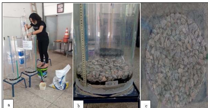
Figura 33 - Preparação da base dos lisímetros
