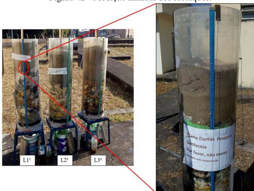
Figura 42 - Medição manual dos recalques.
