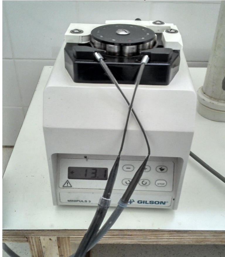
Figura 4.9 – Bomba utilizada na alimentação do reator anaeróbio.
