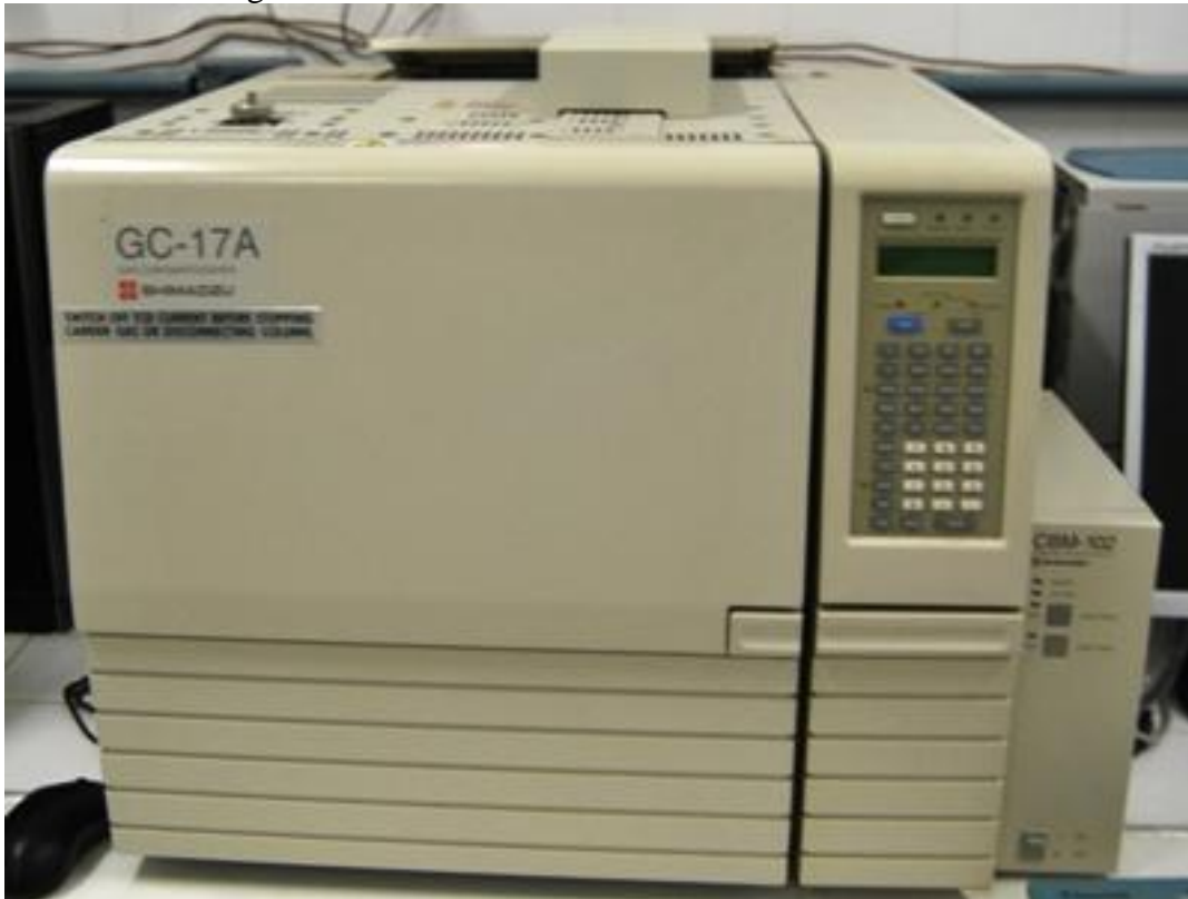
Figura 4.6 – Cromatógrafo GC-TCD utilizado para a determinação e quantificação do metano e gás carbônico no biogás.
