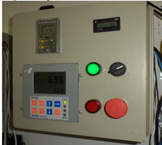
Figura 4.11 – Quadro elétrico para contagem dos pulsos gerados pelo deslocamento do líquido gerado pela produção de biogás.
