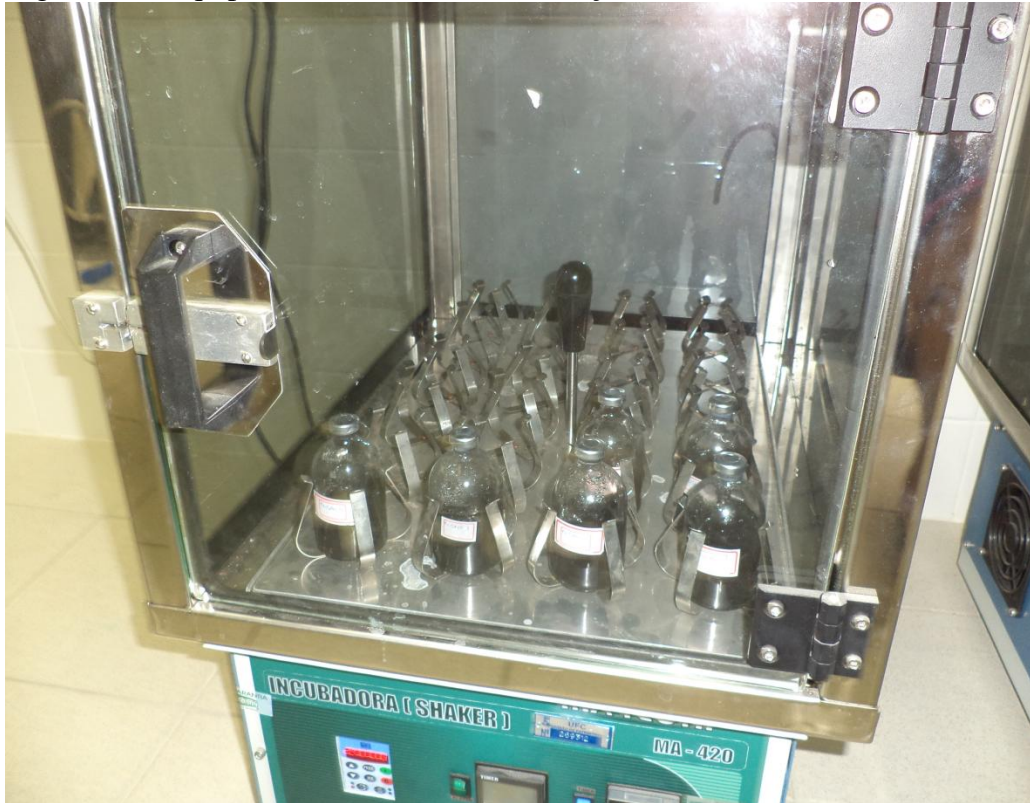
Figura 4.4 - Equipamento utilizado na realização do teste de AME.
