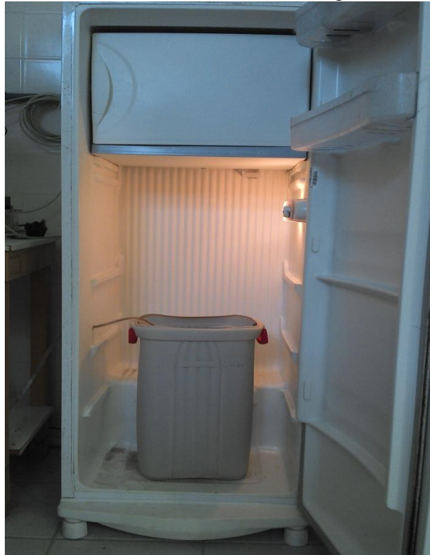
Figura 4.8 – Sistema de condicionamento do afluente (refrigerador + reservatório).
