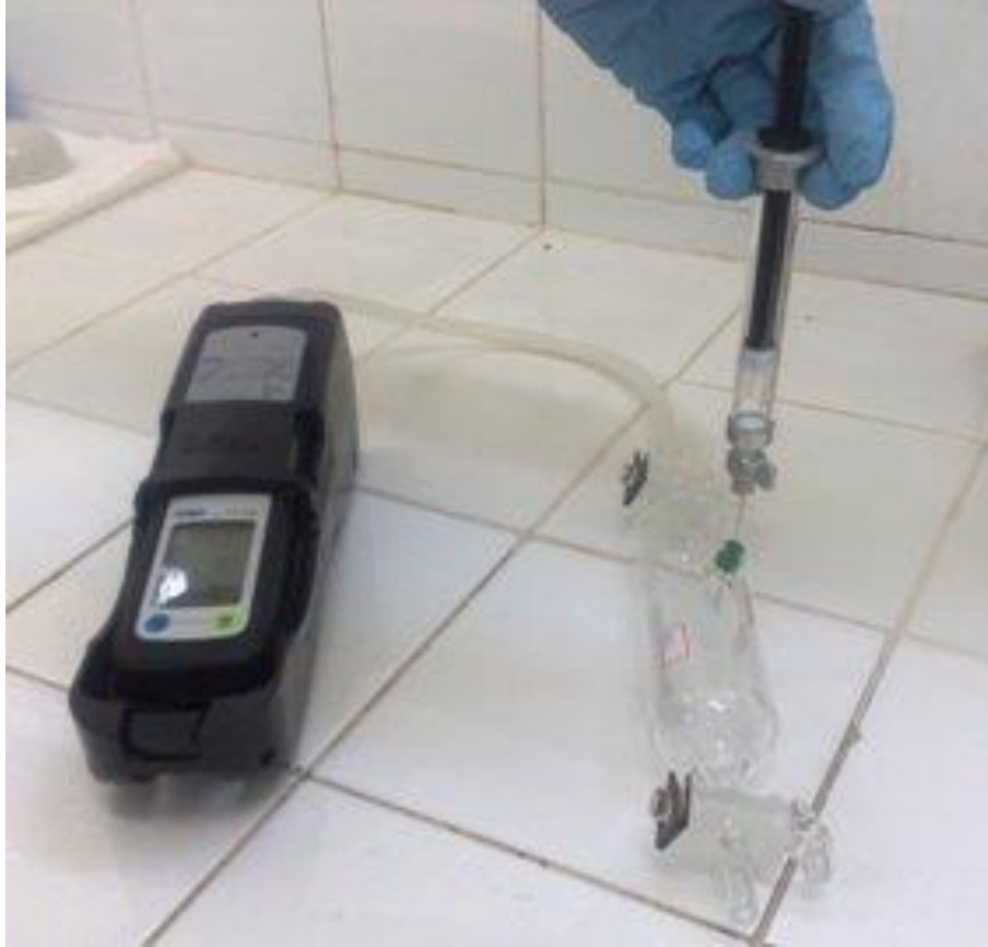
Figura 4.12 - Procedimento de diluição do biogás em bulbo de vidro para quantificação de \text{NH}_3 e \text{H}_2\text{S} .
