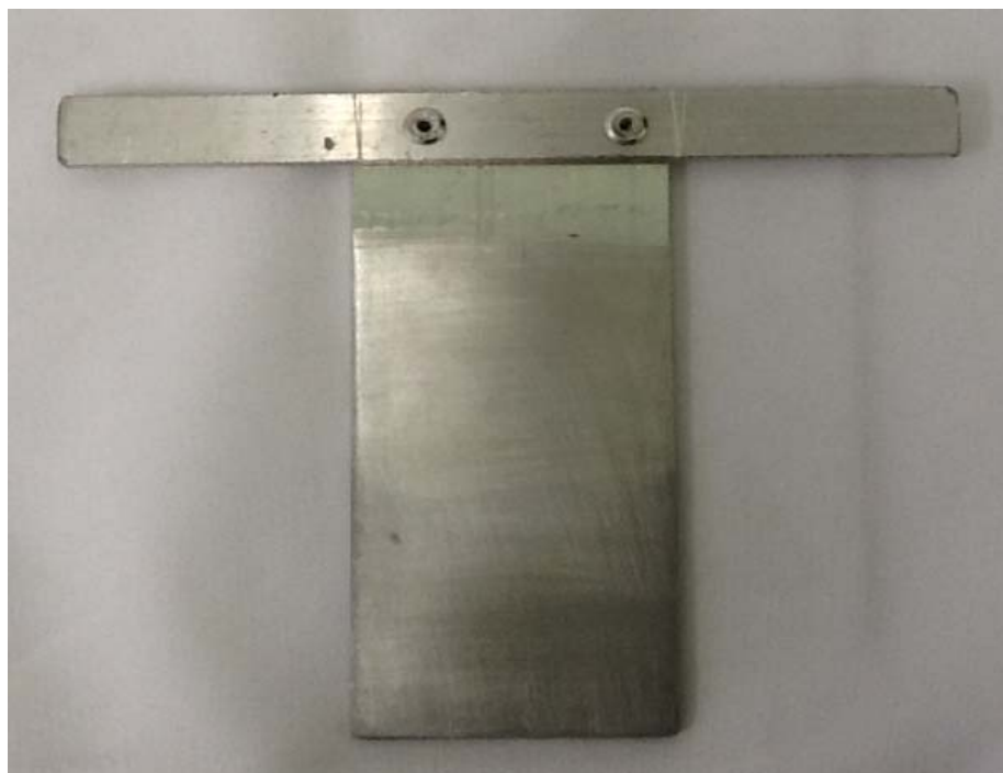
Figura 17 - Eletrodos de alumínio utilizado na eletrocoagulação.
