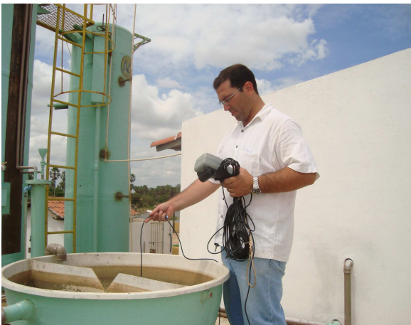
Figura 26 – Procedimento de medição de OD e temperatura no tanque de homogeneização, Aracati-CE (2012).
