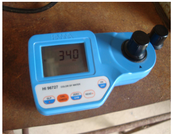
Figura 27 – Procedimento de medição de cor aparente no sistema experimental, Aracati-CE (2012).
