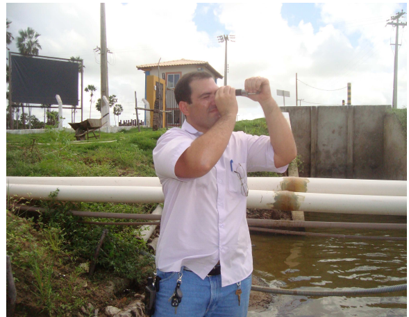
Figura 25 – Procedimento de medição de salinidade na lagoa de sedimentação, Aracati-CE (2012).
