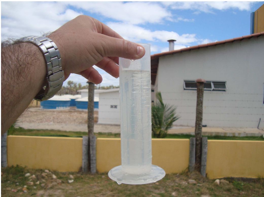
Figura 13 – Vista geral da remoção de sólidos e a qualidade do efluente final produzido pelo sistema combinado de reatores biológicos UASB-FSA, Aracati-CE (2012).
