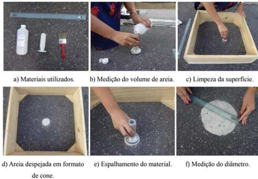
Figura 4 – Etapas do ensaio da mancha de areia.
