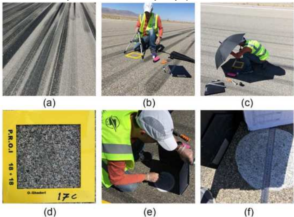
Figura 14 – Coleta de dados de macrotextura da PPD do Aeroporto Internacional de Birjand juntamente de uma captura, com auxílio de um tripé, da porção avaliada.
