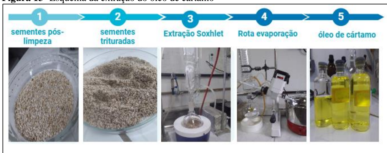
Figura 13- Esquema da extração do óleo de cártamo
