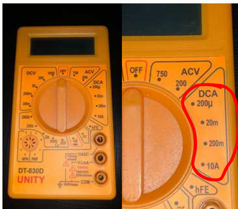
Figura 2.2: Multímetro digital: UNITY DT830 e escala amperímetro.
