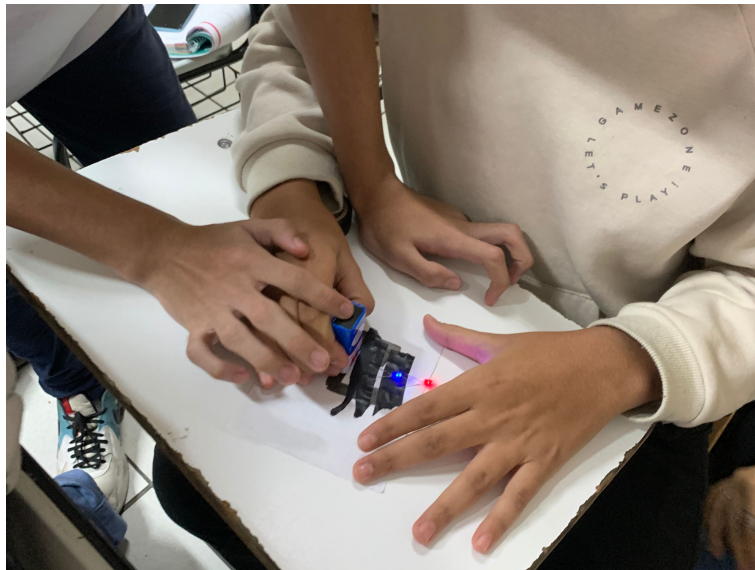
Figura 25 – Ligação do diodo emissor de luz em paralelo feita pelos alunos.
