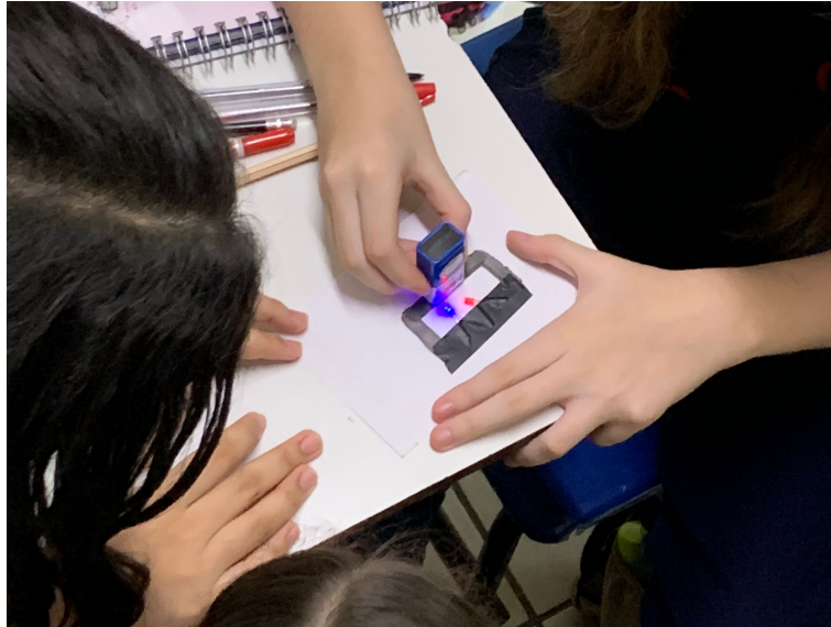
Figura 24 – Ligação do diodo emissor de luz em série feita pelos alunos.
