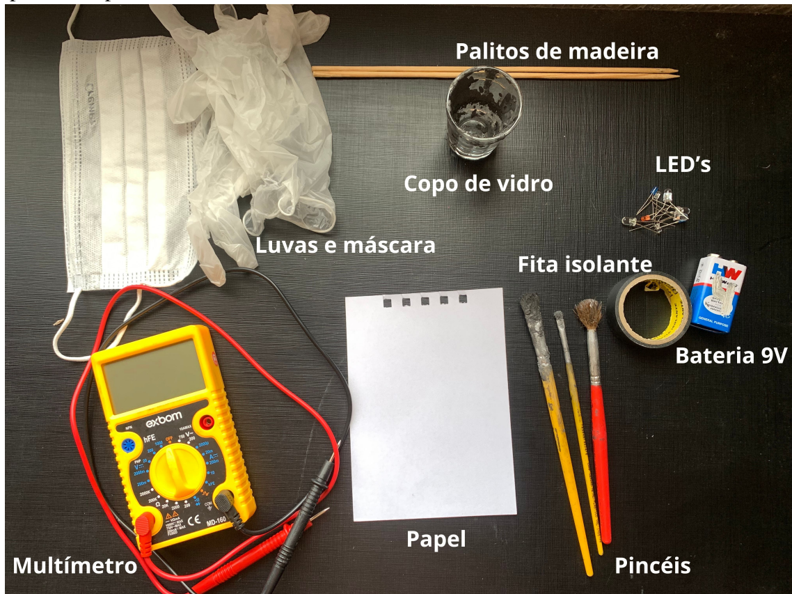
Figura 19 – Materiais necessários para a produção da tinta condutiva e realização das práticas experimentais.
