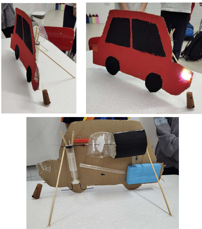
Figura 2 - Maquete produzida por estudantes para o Ciclo de Otto, sob o nome de “Motor de Carro”. Na parte superior: visão lateral e visão frontal (com LED aceso), respectivamente. Na parte inferior: visão da parte de trás, com os elementos da máquina térmica. Fonte: Autora.
