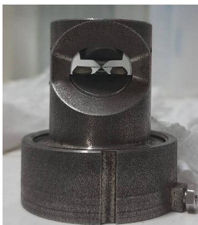
Figura 16 – Célula de bigorna de diamantes Membrane Diamond Anvil Cell , tipo Panoramix , do Laboratório de Altas Pressões do PPGF da UFC.
