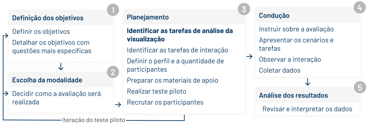
(a) Fluxo de execução da abordagem proposta para avaliação de ferramenta de visualização de rede
