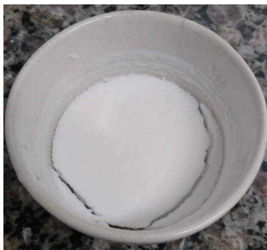
Figura 9 - Suporte SBA-15 na forma de pó fino.
