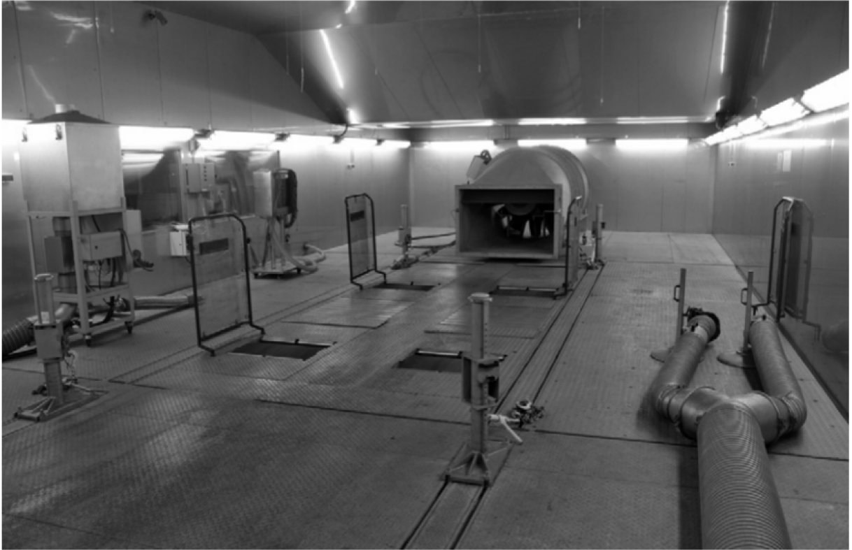
Figura 11 – Exemplo de uma instalação de testes de veículos utilizando um dinamômetro de chassi.
