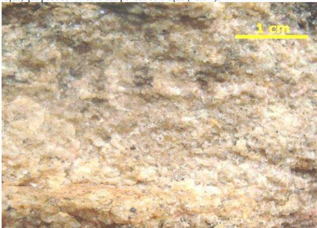
Foto 1 – Fotografia da amostra de rocha analisada, onde encontra-se em estado úmido. Os feldspatos correspondem a pontuações alaranjadas, enquanto às escuras é a biotita.
