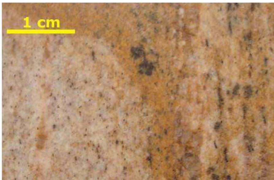
Foto 1 – Fotografia da amostra de rocha analisada em corte transversal a estruturação. A amostra encontra-se em estado úmido. Os feldspatos correspondem a pontuações alaranjadas, enquanto às escuras é a biotita.
