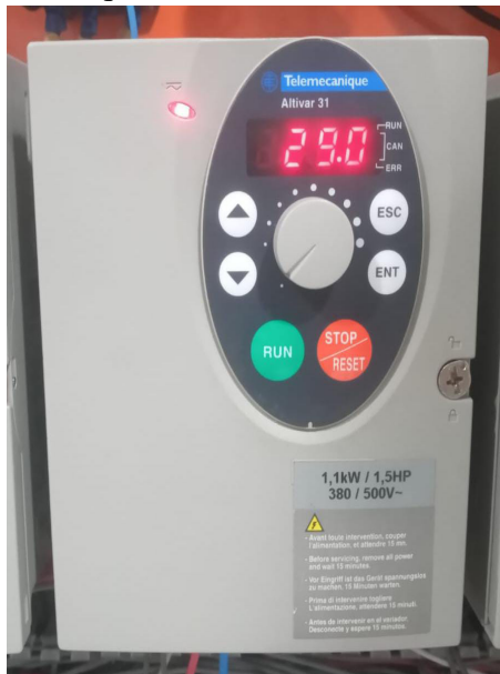
Figura 11 – Fotografia do inversor de frequência.
