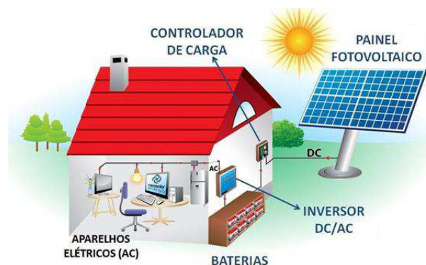
Figura 9 – Esquemático: Sistema solar fotovoltaico
